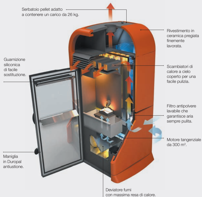
Schema di funzionamento delle stufe a pellet Cadel
